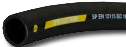
Tankwagenschlauch mit Spirale nach EN 12115. Geeignet für Kohlenwasserstoffe bis 55% Aromatenanteil. Die Decke ist öl-, witterungs- und ozonbeständig. Elektrisch leitfähig ( $R \leq 10^6 \Omega$ ).
